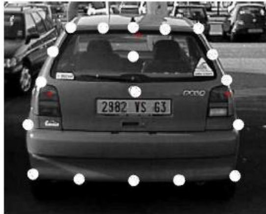
Fig. 9 – Position dans l'image des 18 caractéristiques F_i formant le modèle du véhicule.
